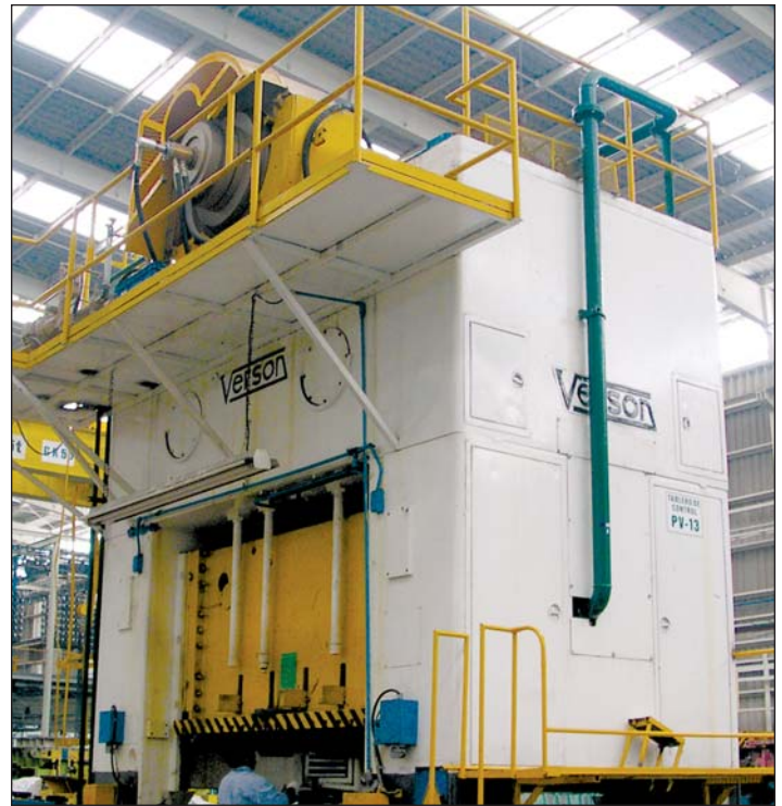
Press Pac® 2232 Separate Clutch & Brake Verson® 600 Ton Stamping Press Installation
